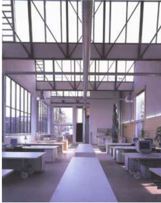
شكل (6-11) استخدام الفتحات العلوية لإضاءة الفراغات العميقة ( مبنى Loft Nurnberg بألمانيا للمعماري Gerhard P.Wirth ) المصدر ( Links International , 2003 )
